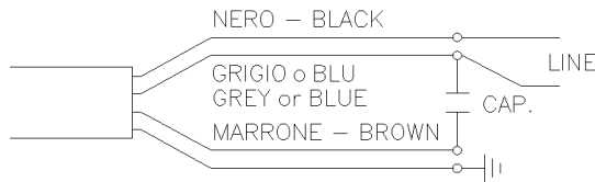
Figura 1: Schema di collegamento per motore 4" serie GG versione monofase Figure 1: Wiring diagram for motor 4" GG series single-phase version Figure 1: Schéma de connexion pour moteur 4" série GG version monophasée Rysunek 1: Schemat podłączenia dla silnika 4" serii GG wersja jednofazowa
